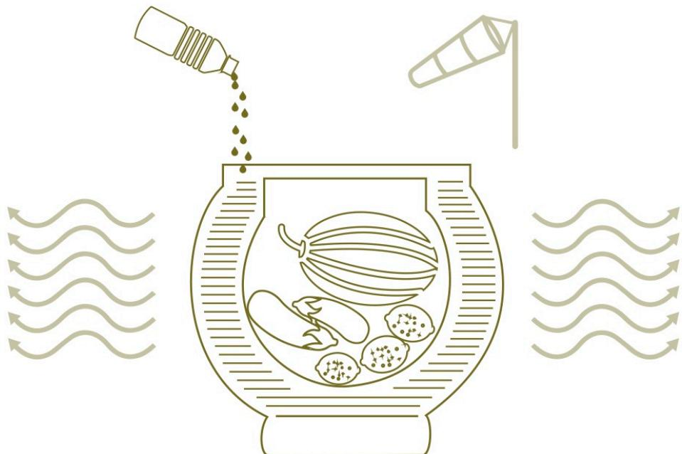
Figure 3. Schéma du projet Frigo du désert, Site internet du Low Tech Lab rubrique « Les tutos »
