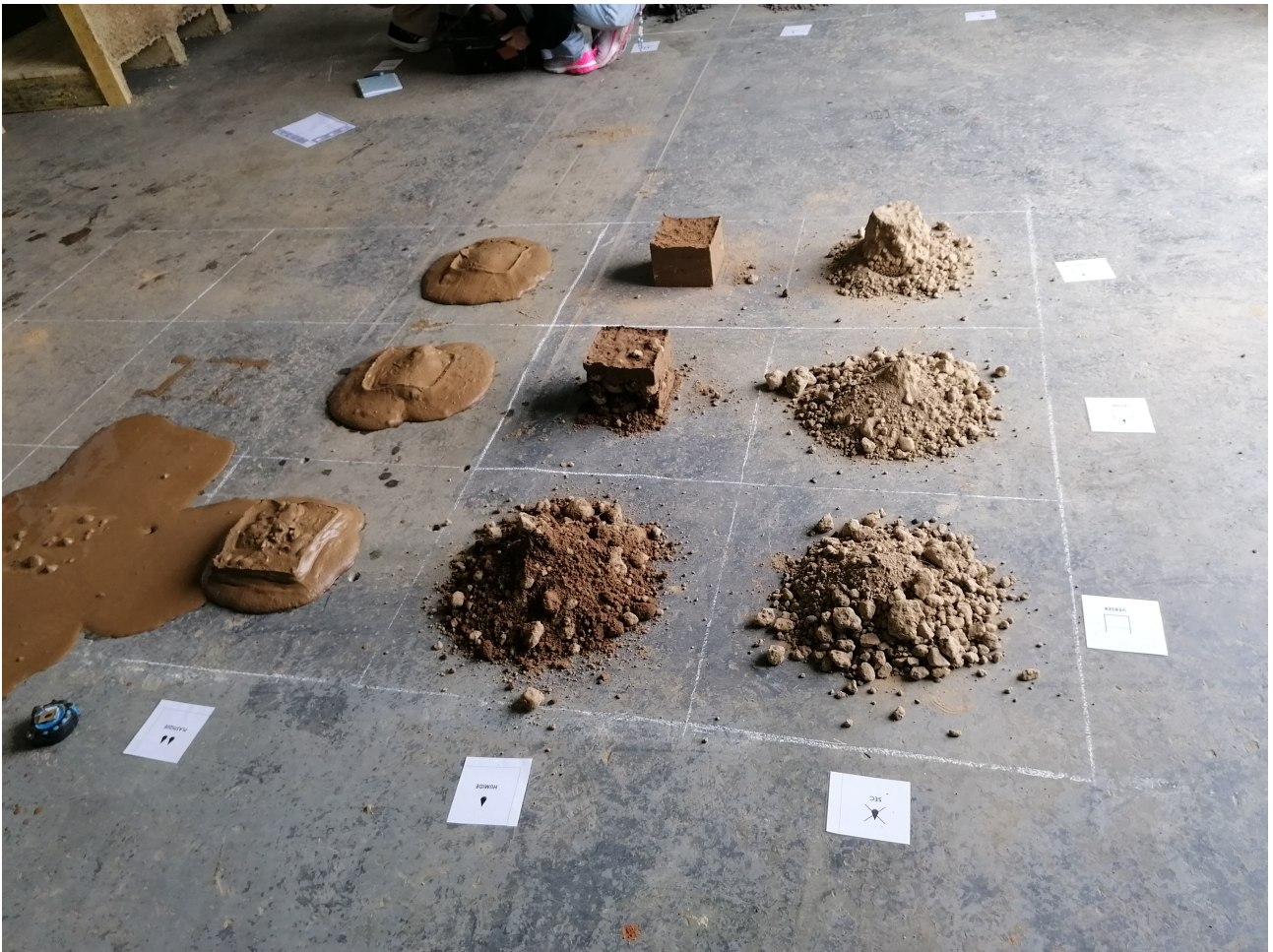
Fig. 3 : Test de Carazas réalisé avec les étudiants du M1 Design situé, milieu et matériaux en 2023. (matériel pédagogique proposé par AMàCO à commander en ligne 17 ).
