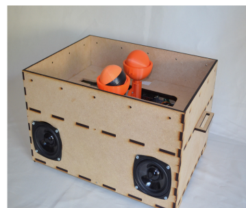
Structure du dispositif, Tala Box, (Hard) 158 x 454 X 340 mm, Raspberry Pi3, écran de contrôle, ampli audio, 2 haut-parleurs et 2 rails linéaires motorisés, 4 moteurs pas à pas, Arduino, Shield CNC. Impressions 3D/PLA, (Soft) traitement signal Python, Librairie Librosa. Boîte HDF et recouvert de Néoprène.
