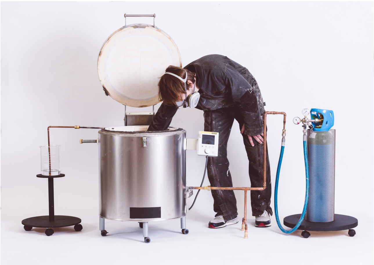
Fig 5. : Four sous atmosphère, créé par Emile De Visscher pour le développement du projet « Pétrification », une recherche pour développer de nouvelles formes d'artisanat céramique distribués et accessibles, 2019.
