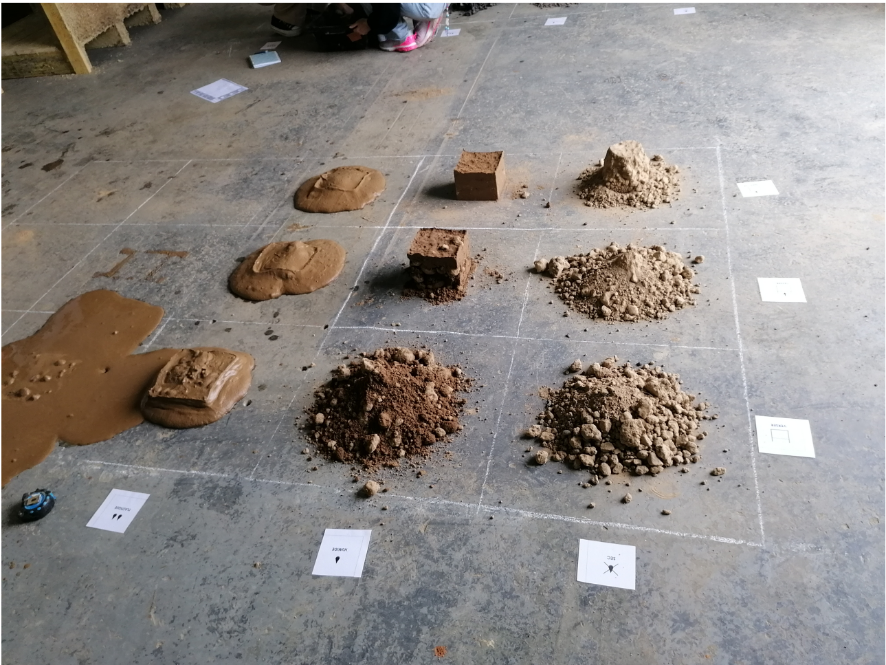
Fig. 3 : Test de Carazas réalisé avec les étudiants du M1 Design situé, milieux et matériaux en 2023. (matériel pédagogique proposé par AMàCO à commander en ligne 17 ).
