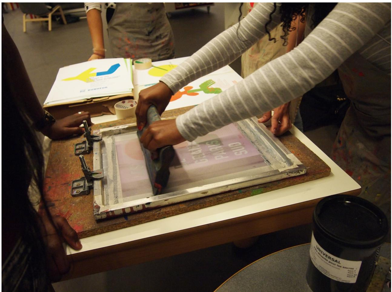
La sérigraphie est une technique assez fréquemment utilisée pour sa simplicité de mise en œuvre et sa mobilité. Image fournie par le collectif Fabrication-Maison.
