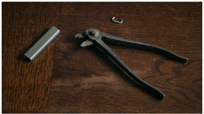
**Fig. 3 :** Une pince Peugeot servant à agrafer la garniture de sièges de voiture, utilisée et conservée par Christian Corouge. *Le Temps des ouvriers*, série documentaire de Stan Neumann, 2020, Les Films d'Ici, Arte FRANCE, AB Productions\*- Capture d'écran.
