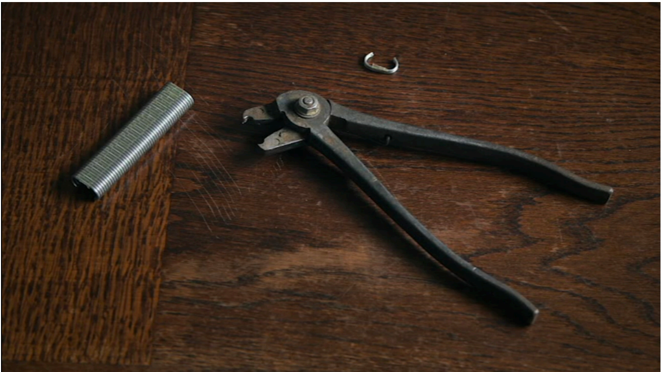
Fig. 3 : Une pince Peugeot servant à agraffer la garniture de sièges de voiture, utilisée et conservée par Christian Corouge. Le Temps des ouvriers , série documentaire de Stan Neumann, 2020, Les Films d'Ici, Arte FRANCE, AB Productions* - Capture d'écran.
